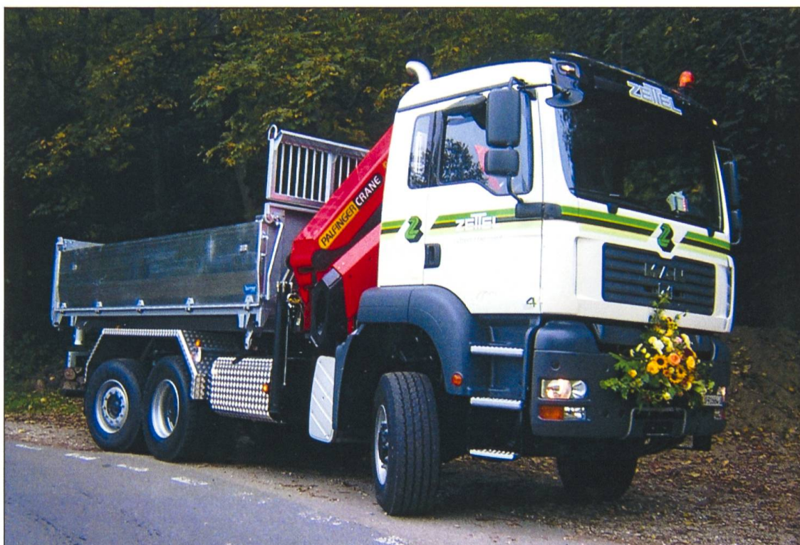
Ein MAN TGA 28.430 6x4 euro4 mit gelenkter dritter Achse erleichterte von 2006 bis 2018 mit seiner ausgezeichneten Kurvengängigkeit die Arbeit im Napfbergland.
