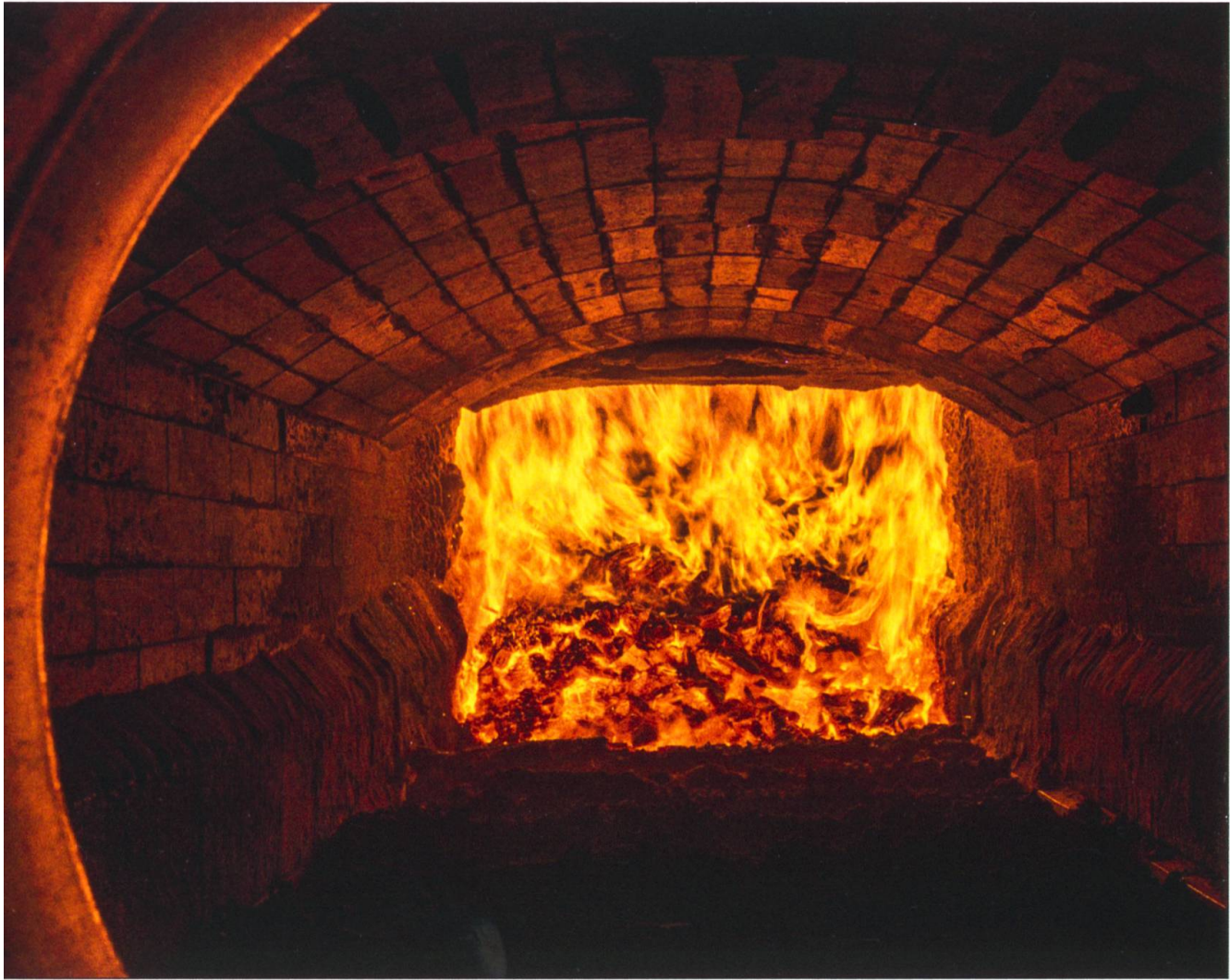
Aus der Produktion anfallendes Restholz wird verbrannt – die entstehende Wärme ersetzt für beinahe alle Haushalte in Luthern das Heizöl.
