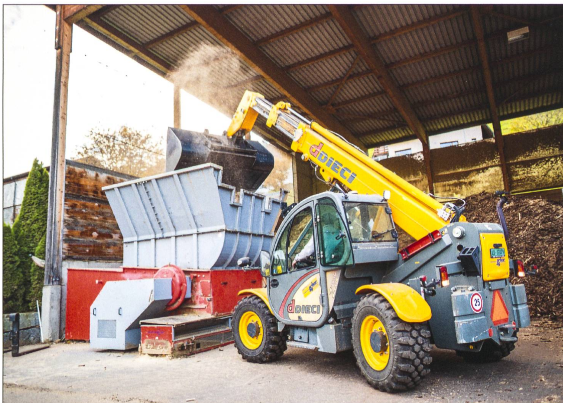
In der Häcksler-Anlage wird das Restholz zerkleinert, um es anschliessend verbrennen zu können.
