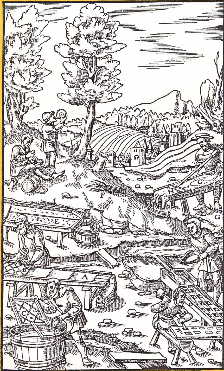
Der Planenherd A. Sein Haupt mit Vertiefungen und Rillen B. Das abgenommene Haupt wird in einem Fasse gewaschen C. Der Herd mit rechteckigen Vertiefungen D. Ein Herd, an dessen Brettern kleine Flitterchen hängenbleiben E. Besen F. Stierhäute G. Die Kiste H.
