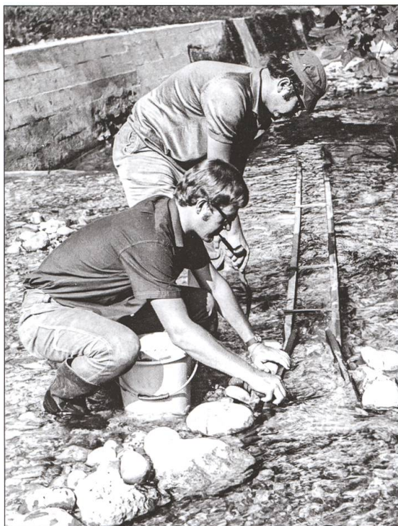
Zwei Willisauer Goldgräber an der Arbeit in der Grossen Fontanne mit dem selbstgebastelten Waschkännel.
