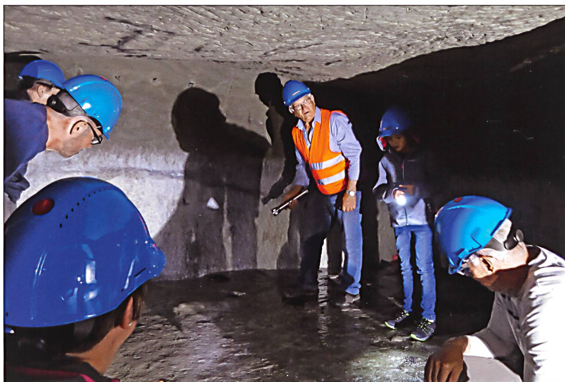
Alois Koller (Mitte) erklärt den Sandsteinabbau. Die hellere Schicht unten ist härterer Sandstein als die obere Schicht.
