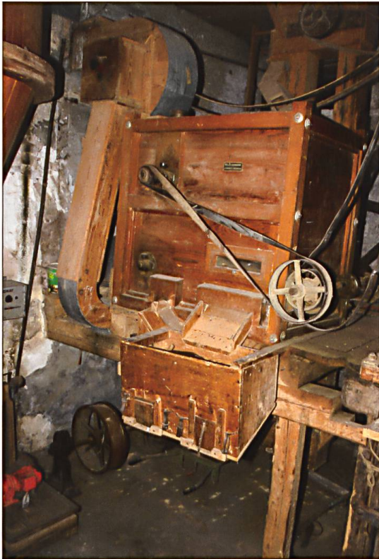
Umluft-Tarar. Hier wird die Spreu vom Korn getrennt und in den Nebenraum geblasen.
