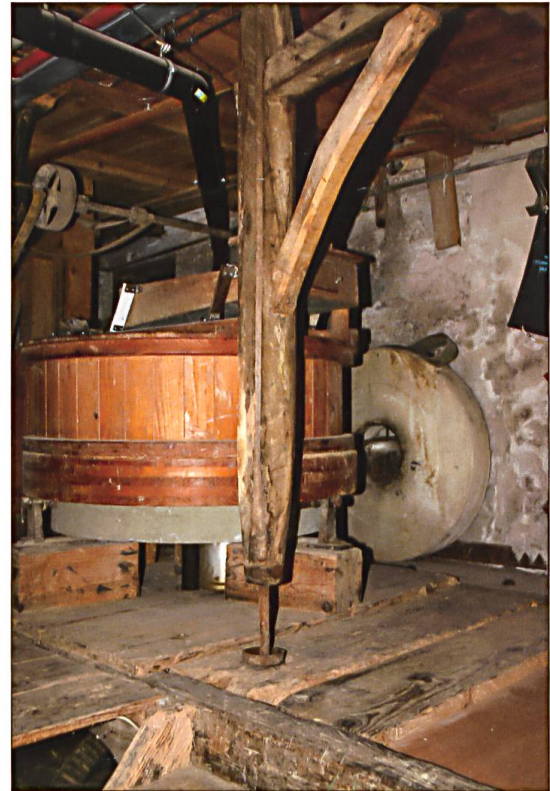
Die Rellmühle oder «Rölle». Im Hintergrund liegt ein zweiter neu behauener Läuferstein bereit. Im Vordergrund der senkrechte Teil des «Galgens», der mit seinem Arm zum Wechseln des Läufersteins diente.
