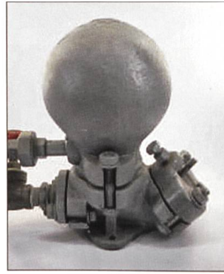
Schlumpf, hydraulischer Widder 1/05 (ab Jahrgang 1905).
