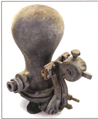
Schlumpf, hydraulischer Widder, Jahrgang 1890.
