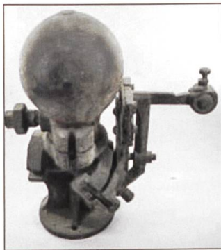
Schlumpf, hydraulischer Widder 1/23 (ab Jahrgang 1923).
