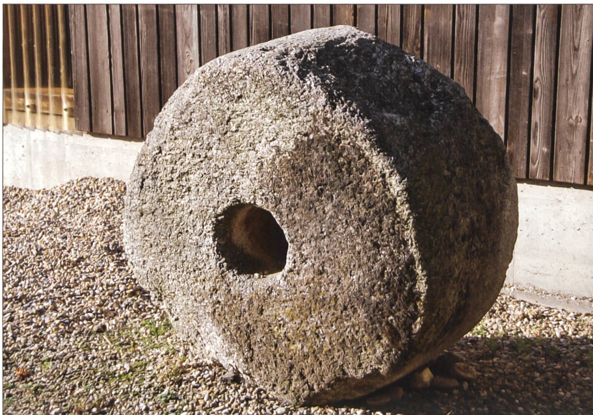
Unlängst kam dieser Mühlenstein beim Kanal zum Vorschein. Er diente der Nebenmühle als Bodenstein. Der aus einem Granit-Findling gebauene Stein ist 1420 kg schwer und hat einen Durchmesser von 125 cm. Er steht heute beim Museum Burgrain. Foto Martin Geiger-Hodel
