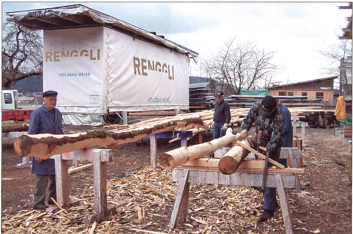
Zurichten des Baubolzes im Holzbauwerk der Firma Renggli, Schötz.
