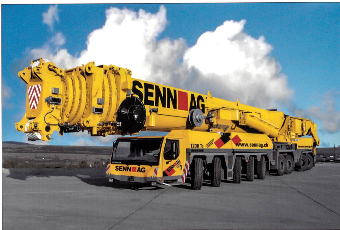
Liebherr-Mobilkran LTM 11200-9, ein schwergewichtiger Wiggertaler. Maximale Traglast 1 200 t bei Ausladung 2,5 m; Maximale Hubhöhe 188 m; Maximale Ausladung 136 m.
