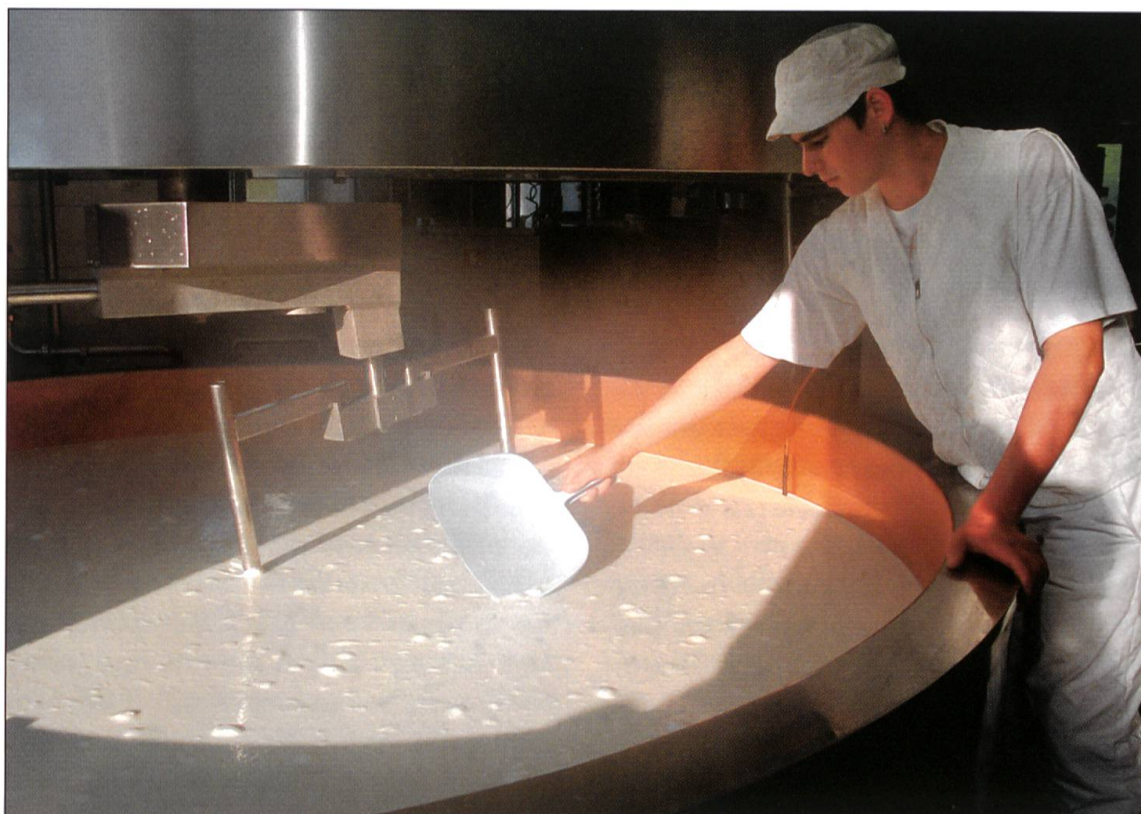
Stefan Schmid, Lehrling im zweiten Lehrjahr, beobachtet die Stilllegung der Milch im Kessi. Nach dem Rühren dauert es rund 40 Minuten, bis die Milch geronnen ist und er sie mit der Käsebarfe in Stücke zerschneiden wird. In der Napf-Chäsi AG kann der erfahrene Käser diesen Vorgang noch beobachten und eingreifen. In industriellen Betrieben laufen alle diese Prozesse in geschlossenen Systemen ab.
