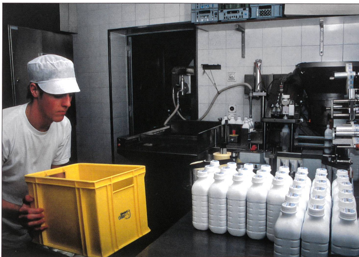
Roman Häfliger, Lehrling im dritten Lehrjahr, bedient die Abfüllanlage. Die Pasteurisierungsmaschine ist hinten rechts zu sehen. Pro Tag werden 1000 bis 1500 Liter Pastmilchflaschen gefüllt und selber etikettiert. Etwa 100 Liter werden im eigenen Laden verkauft, der Rest wird an Gastrobetriebe und Detaillisten bis nach Horw oder Walde AG geliefert.
