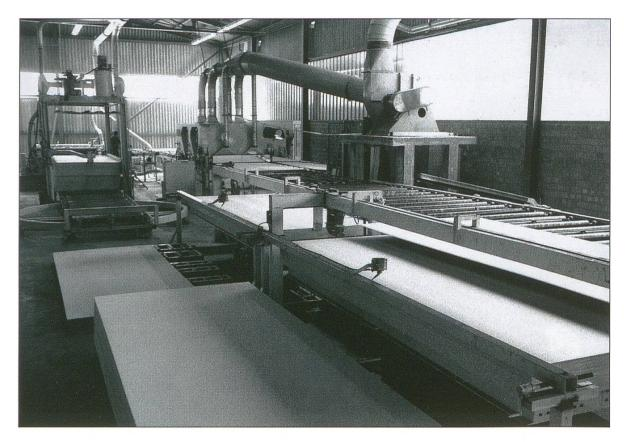
Erste Schleif- und Sortieranlage für Spanplatten.
