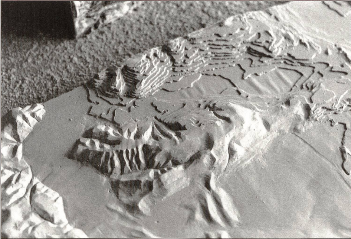
Dieses Gumminegativ dient als Grundlage. Davon wird ein Gipsabguss genommen, der dann als Basis für die späteren Reliefs dient.
