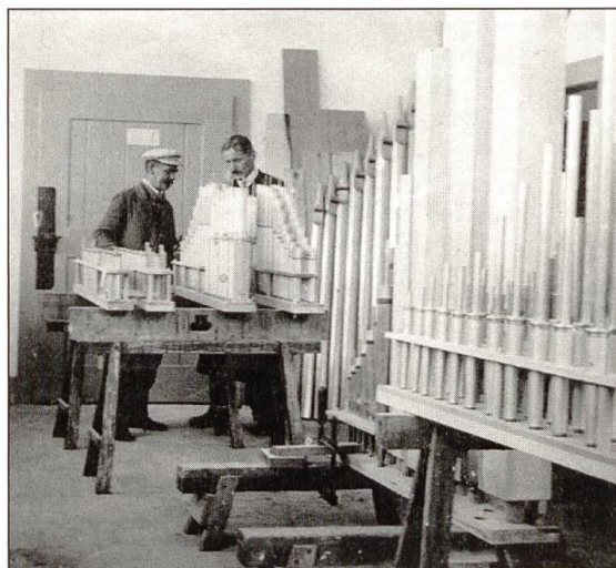
Blick in die Orgelbauwerkstatt. Einrastriren (Einpassen) von Pfeifen in der Orgelbau AG Willisau, rechts der Orgelbauer Kilian Fischer (Foto undatiert).
