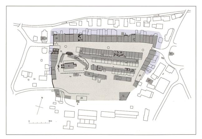
Abbildung 2: Katasterplan von 1990. Die mittelalterliche Stadtanlage des 14/15. Jahrhunderts ist mit dunkelgrauem Raster eingezeichnet (nach archäologischen und archivalischen Quellen). Der Standort erwähnter Bauwerke und Werkstätten ist mit Nummern bezeichnet. Für gewisse Gebäude ist auch der Standort ab 1704 eingetragen.
