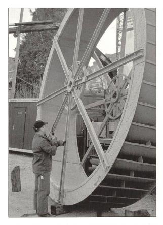
Das Wasserrad wiegt rund 2,5 Tonnen und hat einen Durchmesser von 434 Zentimetern und eine Breite von einem Meter.
