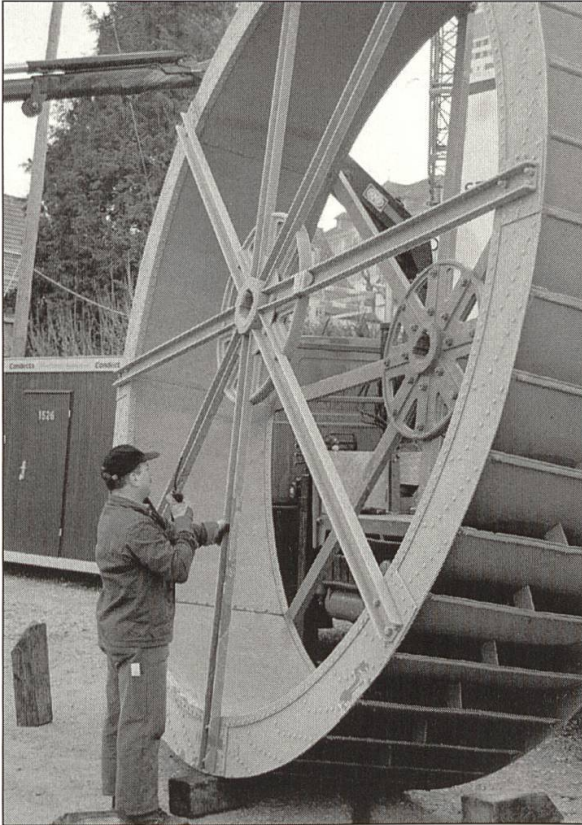
Das Wasserrad wiegt rund 2,5 Tonnen und hat einen Durchmesser von 434 Zentimetern und eine Breite von einem Meter.
