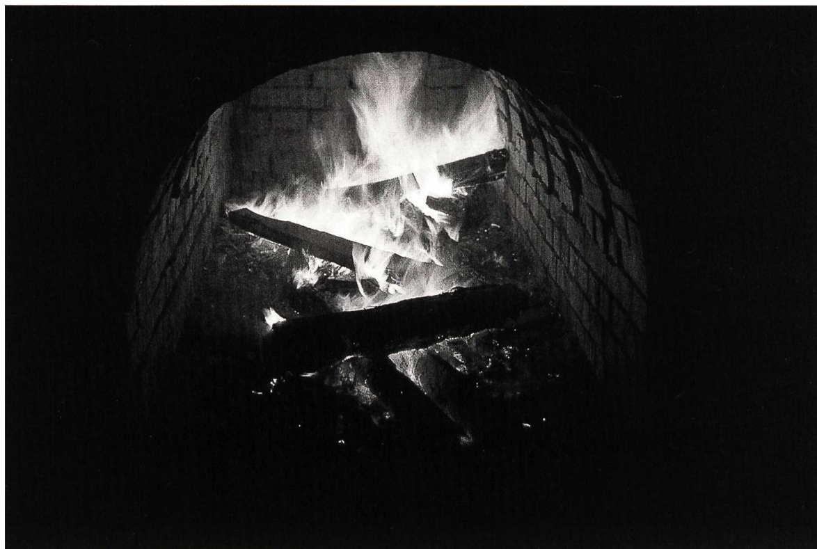
Abbildung 12: Das Brennholz sollte in einer Zickzacklinie im Feuerungskanal liegen.
