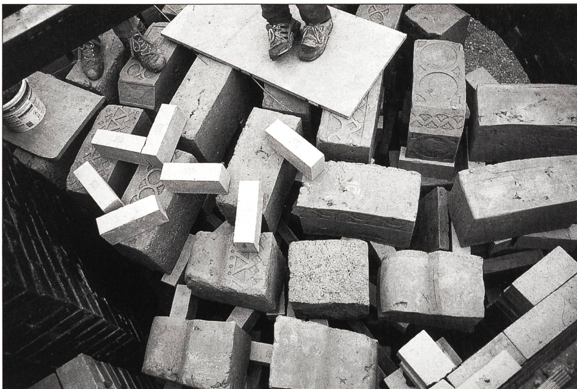
Abbildung 9: Beschicken des Ofens. Blick auf die dritte Lage der grossformatigen Rohlinge.
