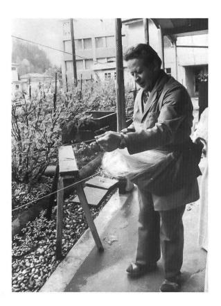
Der Seiler führt behutsam das Leitholz, welches durch die Verdrehung der Litzen vorangetrieben wird.
