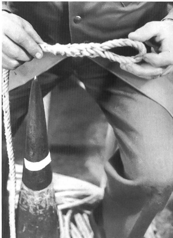
Die Enden der Hanfseile werden mit Hanfbindfaden solide abgebunden, damit sie nicht ausfransen können. Hier entsteht ein «Überwurf».
