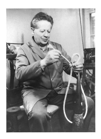
Herstellung einer Schlaufe am Lätsch-Stock. Das dünnere Ende des Strickes wird durch das «Auge» des dickeren gezogen.
