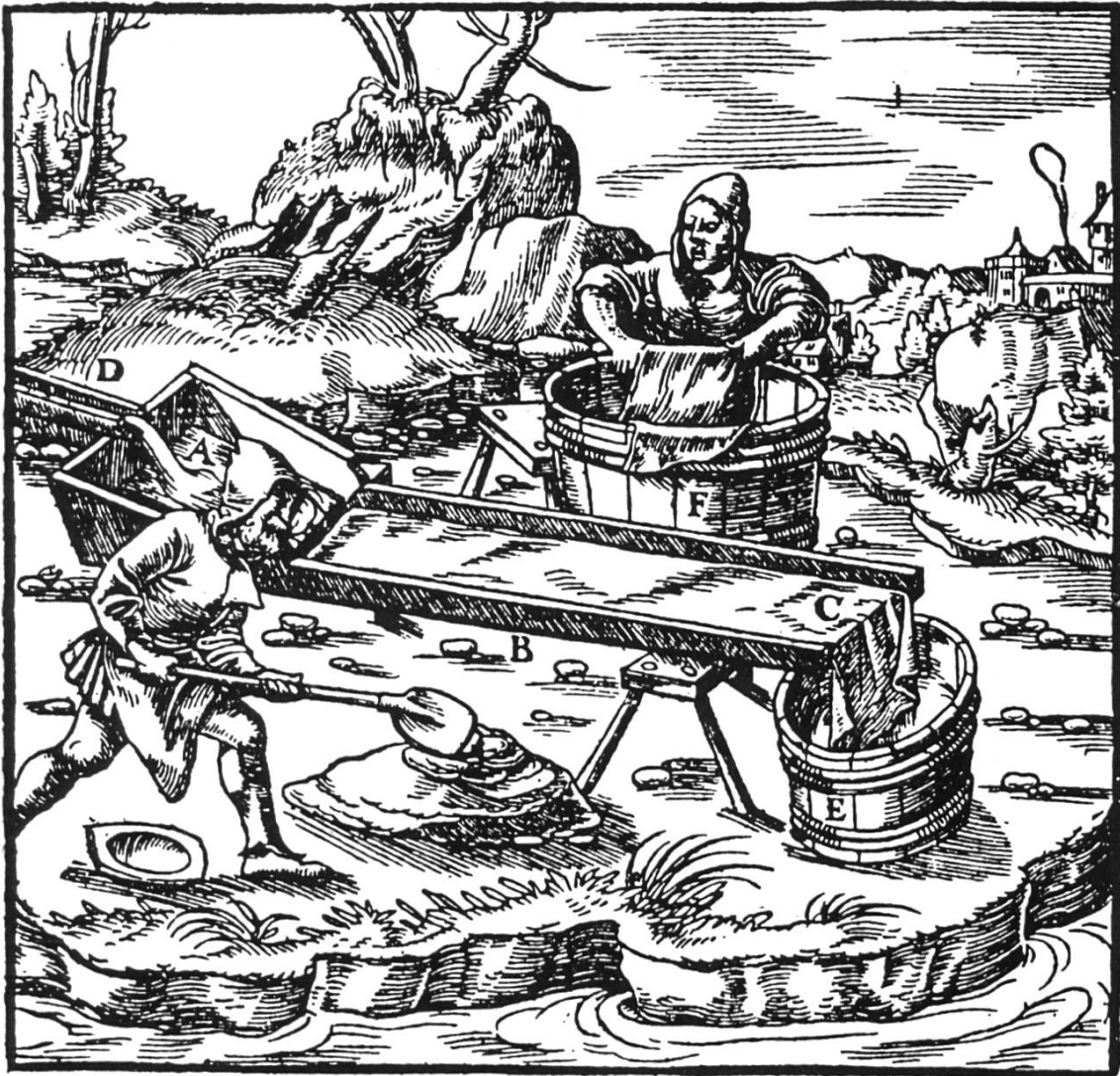
Figur 2: Das traditionelle Goldwaschen. Diese Methode des Abbaus alluvialer Goldlager ist schon Jahrtausende alt. Goldhaltiger Sand und Kies wurde auf ein mit Tüchern oder Fellen belegtes Schrägbett geschaufelt und ausgewaschen, bis das Gold als Staub oder Flitter zurückblieb.
