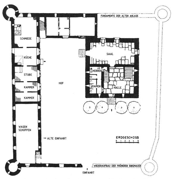
Schloss Wyher: Grundriss des Erdgeschosses, Entwurf für den Wideraufbau 1982.
