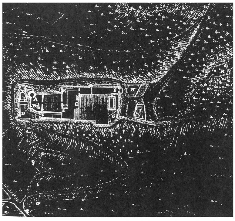
Situationsplan des Schlosses Wikon aus der Zeit des 2. Villmergerkrieges um 1712 (Photoarchiv der Denkmalpflege Luzern). A) Rundturm der vordern abgegangenen Burg. B) Plattform, von welcher der Eingang C gedeckt wird. D) Unterer Zwinger beim untern Eingang zum Schloss. E) Flankierender Gang von AE. F) Haupttor mit Schildmauer und Fallbrücke. H. u. I.) Vorgelagerte Schanzen mit Passage für den Burgweg. K) Ummauerter Hof der Hochwacht mit Wächterhäuschen und dem aufgeschichteten Holz in der Mitte.
