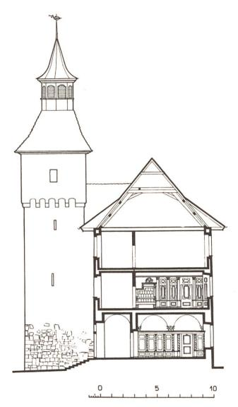
Willisau. Landvogteischloss erbaut 1690–1695. Querschnitt Nord-Süd mit Blick gegen Westen. Massstab 1:300 KDLU Bd V 268/269.
