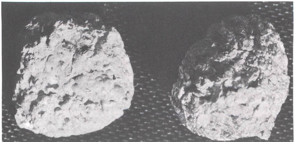
Goldamalgam links, Gewicht 3,5 g; rechts Gold nach dem Ausglühen, Gewicht 0,7 g.
