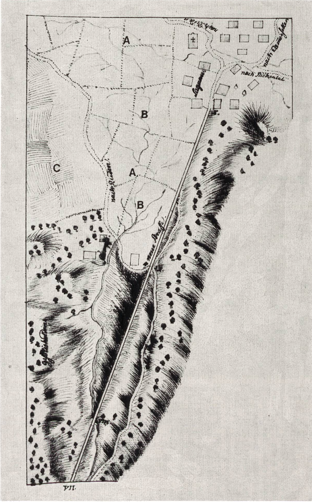
Aus den Plänen des Abtes Karl Ambros Glutz von St. Urban über die Korrektion der alten Langnauer Landstrasse von 1795. Das Bild zeigt das Strassenstück östlich des Dorfes Langnau (VIII-IX-X). Rechts der geradlinig geplanten neuen Strasse ist der alte, krumme Weg zu sehen. Links von Dorf und Strasse liegen die von Hägen (A) eingeschlossenen Wassermatten. Ganz deutlich ist das dichte System von Bewässerungsgräben (B) zu erkennen. Noch weiter links von den Wassermatten liegen die Ackerfelder (C). (Sch 2147 A)
