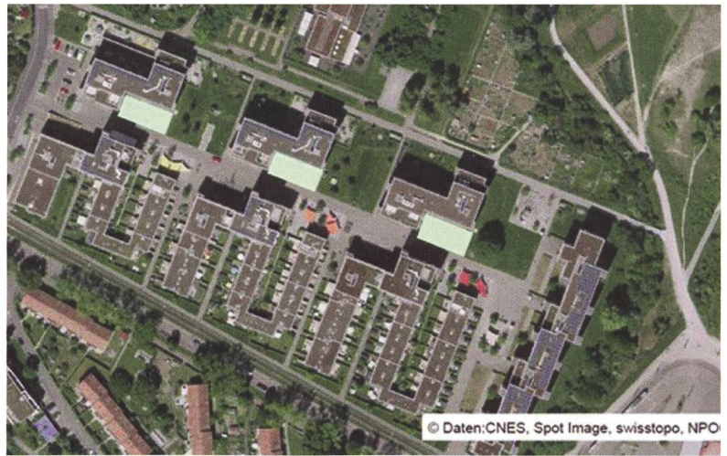
Bild 6: Nachträglich angepasste Begrünung in einer Siedlung. Die Fliessrichtung des Wassers zeigt die Lage der früheren Regenwasserrinne. Rechts sind die entsiegelten Flächen mit hellen Quadraten eingezeichnet (Foto: M. Steiner).
