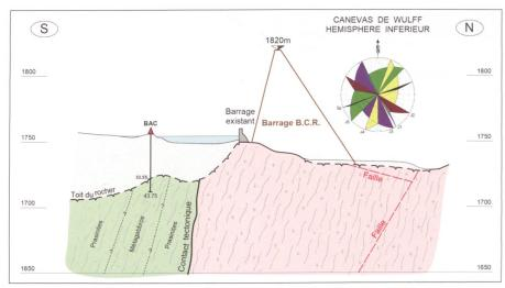
Figure 1 : Illustration d'une coupe géologique interprétative (projet de barrage en béton compacté au rouleau en Suisse).
