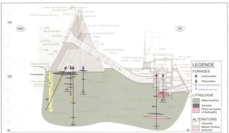
Figure 4: Illustration de la mise en place d'équipements de surveillance dans les fondations d'un barrage et d'une des centrales d'Inga, comprenant des piézomètres (en vert) et des inclinomètres (en rouge) – RDC.
