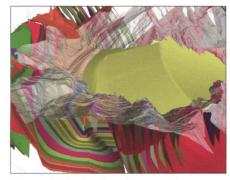
Figure 2: Illustration d'un modèle géologique 3D préparé pour la conception d'un grand barrage (en jaune) en Asie centrale. Il comprend tous les releves géologiques (souterrains et de surface), les données géophysiques, les forages et les essais in situ, ainsi que le barrage et les structures annexes.
