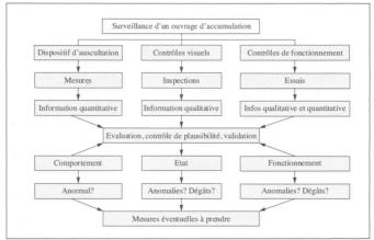
Figure 5: Processus de surveillance d'un ouvrage d'accumulation (Schleiss et Pougatsch, 2011).
