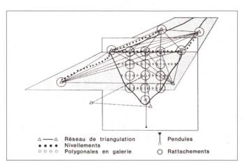
Figure 4: Schéma d'un réseau de mesure spatial (Biedermann, 1997).
