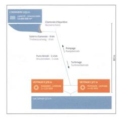
Bild 10: Schema des FMHL-Pumpspeicherkraftwerks Veytaux I + II im Waadtland (FMHL).
