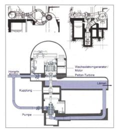
Bild 12: Anordnung des Turbinen-Pumpsystems Veytaux I (oben). Veytaux II: ternäres System mit Peltonturbine und mehrstufiger Pumpe (unten).
