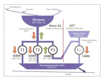
Bild 22: Vereinfachtes hydraulisches Anlageschema der Erneuerung KW Ritom mit Integration KW Stalvedro.
