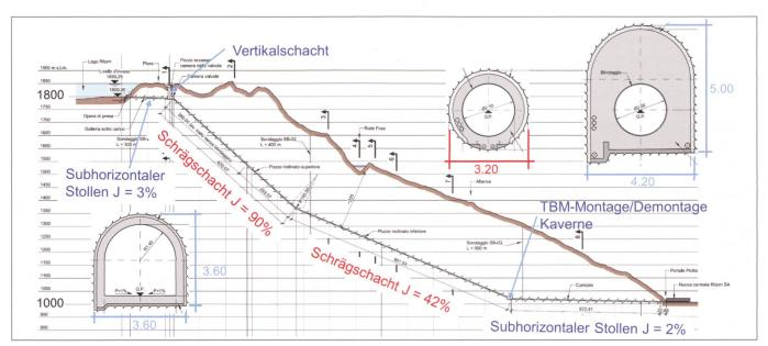
Bild 23: Längs- und Querschnitte Triebwassersystem KW Ritom mit Druckstollen, Druckschacht (J = 90/42 Prozent), Horizontalstollen (J = 2 Prozent) und Zentrale.
