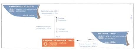
Bild 19: Synoptisches Schema des Pumpspeicherwerks Nant de Drance.
