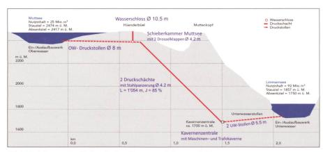
Bild 15: Längenprofil durch das Pumpspeicherwerk Limmern.
