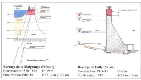
Figure 1: Barrages de la Maigrauge et de Fully.
