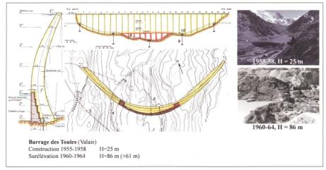
Figure 6: Barrage des Toules. À droite, photos des deux étapes de construction. À noter que ce barrage a encore été conforté entre 2008 et 2011 sur sa face aval, à l'aide d'environ 60000 m³ de béton. Ceci n'est pas représenté sur la figure ci-dessus.
