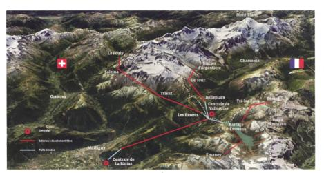
Figure 11: Schéma de l'aménagement d'Émosson-vue 3D.
