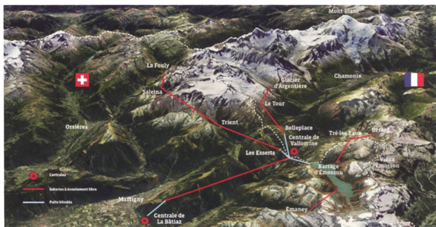
Figure 11: Schéma de l'aménagement d'Émosson – vue 3D.
