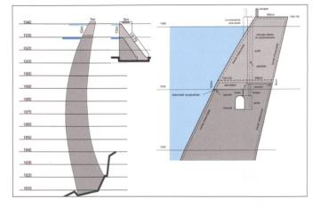
Figure 13: Projet de surélévation du barrage d'Émossonréservoir inférieur.
