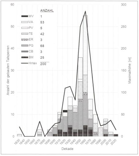
Bild 1: Entwicklung der Talsperren in der Schweiz nach Typ inkl. der maximalen Sperrenhöhen (Hmax) pro Dekade (links) und Verteilung der Talsperren nach maximaler Höhe über der Fundation (rechts); Klassifizierung nach ICOLD: BM = Wehr, CB = Pfeilerstaumauer, ER = Steinschüttdamm, MV = Gewölbestaumauer, PG = Gewichtsstaumauer, PV = Bogengewichtsstaumauer, TE = Erdschüttdamm, VA = Bogenmauer (eigene Darstellung).
