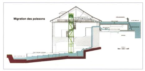
Bild 11: Fischlift zur stromaufwärts gerichteten Fischwanderung an der Talsperre Maigrauge (FR).
