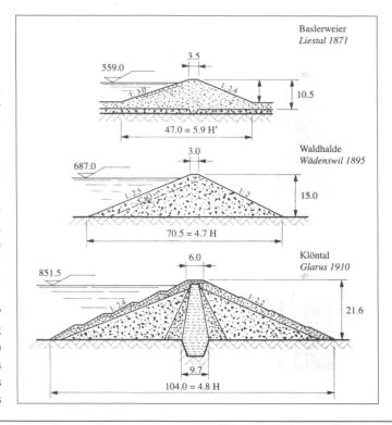
Figure 2: Exemples de barrages en remblai construits vers la fin du XIXe siècle et le début du XX<sup>e</sup> siècle (selon Schnitter, 1985).
