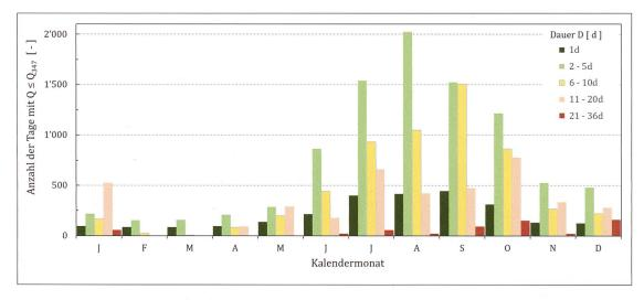
Bild 4: Verteilung der Ereignistage des Q<sub>347</sub> für verschiedene Dauern D [d] und Kalendermonate.
