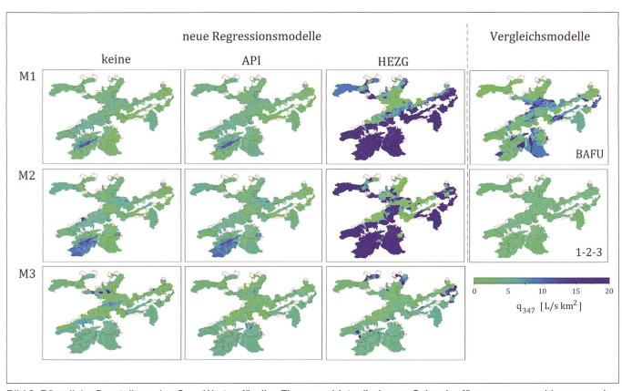
Bild 8: Räumliche Darstellung des  $Q_{347}$  -Wertes für die «Einzugsgebietsgliederung Schweiz» für neun vorgeschlagene und zwei Vergleichsmodelle. Weisse EZG bedeuten «nicht modelliert», weil reguliert oder Kanäle.
