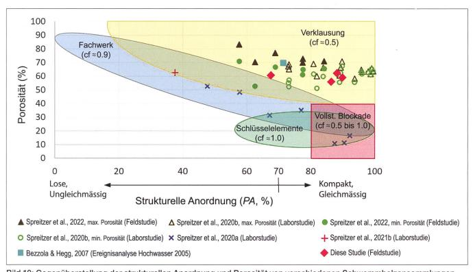
Bild 10: Gegenüberstellung der strukturellen Anordnung und Porosität von verschiedenen Schwemmholzansammlungen. Die Einteilung der Verklausungstypen (Schlüsselelemente, Fachwerke, komplexe Verklausungen und vollständige Blockaden) erfolgte nach Manners und Doyle (2008). Zur Ermittlung der empirischen Porosität (nemp) wird je nach Verklausungstyp ein Korrekturfaktor (cf) empfohlen (adaptiert von Spreitzer et al. (2022b).
