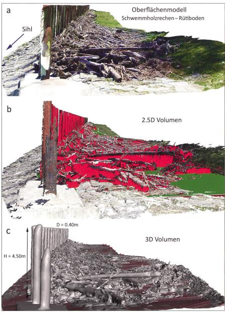
Bild 5: Diverse Modelle und Volumina sowie Vermessung der Schwemmholzansammlung an der Sihl – Rütiboden nach einem Hochwasser (HQ<sub>30</sub>) im Sommer 2021.
