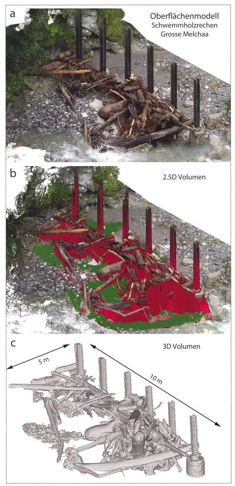
Bild 8: Diverse Modelle und Volumina sowie Vermessung der Schwemmholzansammlung am Rückhaltebauwerk an der Grossen Melchaa.
