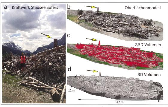
Bild 7: Diverse Modelle und Volumina sowie Vermessung der Schwemmholzansammlung am Lagerplatz beim Stausee Sufers.
