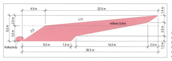
Bild 8: Normalie der langen Buhne, so wie sie im Jahr 2017 in der Hunzigenau eingebaut wurde.
