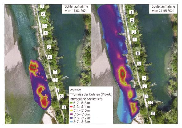
Bild 20: Rasterinterpolation der mittels Echolotpeilmessung erhobenen Sohlenhöhe im März und im Mai 2021 bei Abflüssen von ca. 90 m³/s resp. ca. 165 m³/s.
