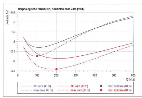
Bild 5: Morphologische Kolktiefe nach Zarn (1997) für Sohlenbreiten von 60 und 80 m. Die maximale Kolktiefe wird bei Abflüssen von 150 bis 200 m³/s erreicht, der mittlere Abfluss bei der Messstation Bern Schönau beträgt ca. 120 m³/s.
