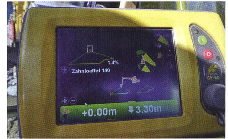
Bild 13: Auf dem Display im Bagger sieht der Baggerfahrer seine Position in der Situation, in einem Schnitt sowie in der Arbeitsachse. Mithilfe der hinterlegten 3D-Pläne können Blöcke auch ohne gute Sicht im tiefen und fliessenden Wasser mit einer ausreichenden Genauigkeit eingebaut werden.
