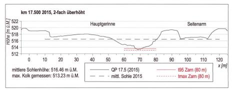
Bild 6: Im Jahr 2015 im Auftrag des BAFU gemessenes Querprofil der Aare bei km 17,5 mit berechneten Kolktiefen nach Zarn (1997) für eine Sohlenbreite von 80 m.
