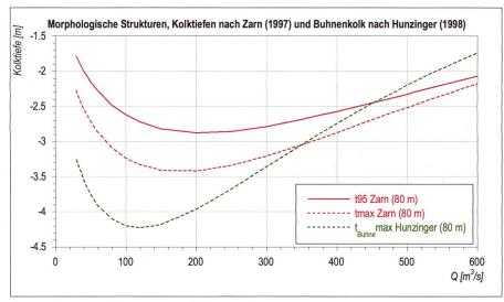
Bild 7: Maximale Buhnenkolktiefe nach Hunzinger (1998) und morphologische Kolktiefe nach Zarn (1997) für eine Sohlenbreite von 80 m. Die maximale Buhnenkolktiefe wird bei Abflüssen von rund 120 m³/s erreicht, dies entspricht ca. dem mittleren Abfluss der Aare bei der Messstation Bern Schönau.
