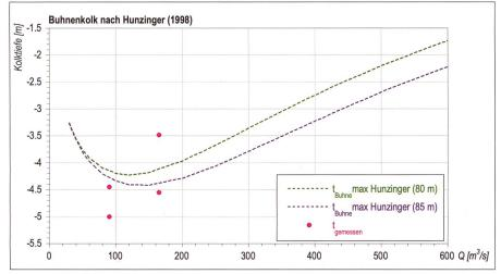
Bild 21: Maximale Buhnenkolktiefe nach Hunzinger [2] für Sohlenbreiten von 80 und 85 m. Die maximale gemessene Tiefe von rund 5 m unter die mittlere Sohle wurde bei einem Abfluss von ca. 90 m³/s aufgenommen. Die gemessenen maximalen Kolktiefen sind 0,2–0,6 m tiefer als dies mit dem herkömmlichen Ansatz berechnet wurde.
