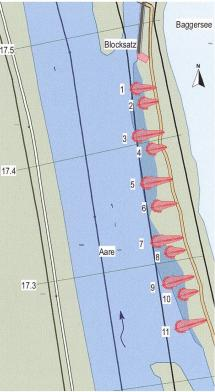
Bild 12: Situationsplan der Buhnen mit Nummerierung.
