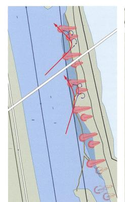
Bild 11: Für die ideale Anordnung der Buhnen wurde die Bandbreite der möglichen Anströmwinkel auf das rechte Ufer inkl. Bildung der Widerwasserströmungen abgeschätzt.
