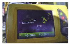
Bild 13: Auf dem Display im Bagger sieht der Baggerfahrer seine Position in der Situation, in einem Schnitt sowie in der Arbeitsachse. Mithilfe der hinterlegten 3D-Pläne können Blöcke auch ohne gute Sicht im tiefen und fliessenden Wasser mit einer ausreichenden Genauigkeit eingebaut werden.
