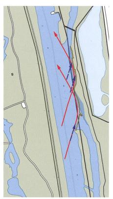
Bild 9: Der Anströmwinkel auf das rechte Ufer bei einem Abfluss von rund 60 m³/s wurde aus der bei diesem Abfluss aufgenommenen Uferlinie mit frischem Uferabbruch abgeleitet (vgl. auch Bild 10).
