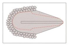
Bild 22: Situation der überarbeiteten Buhnennormalie im Vergleich zur eingebauten Buhne (orange gestrichelt).
