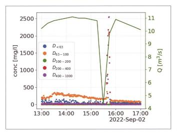
Bild 10: Grössenklassenverteilung einer Spülung am 2. September.
