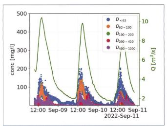
Bild 6: Grössenklassenverteilung bei niedrigem Durchfluss.
