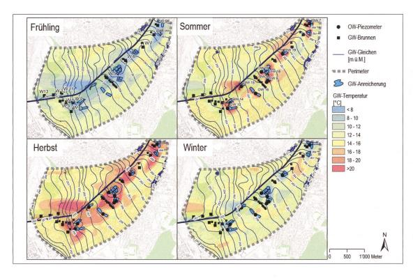
Bild 3: Hydraulisches und thermisches Grundwasserregime für die verschiedenen Jahreszeiten 2018 in den Langen Erlen im Frühjahr (1. April), im Sommer (14. Juli), im Herbst (4. Oktober) und im Winter (3. Januar). **OW: Observation** Well, GW: Grundwasser. Quelle Landeskarte: swisstopo.
