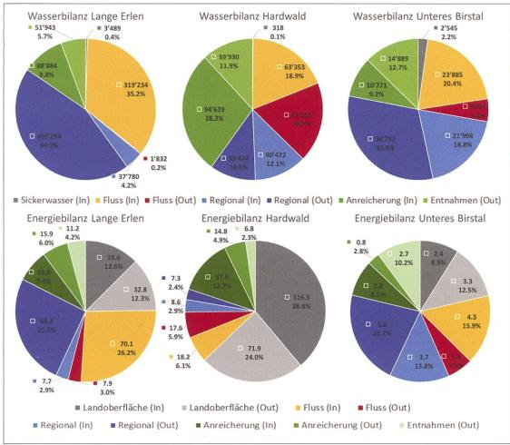
Bild 6: Wasserund Wärmebilanzen für den «Ist-Zustand» für ausgewählte Modellrandbedingungen in den Langen Erlen (links), dem Hardwald (Mitte) und im Unteren Birstal (rechts).
