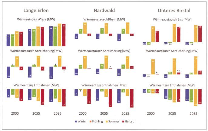
Bild 7: Zusammenfassende Darstellungen des saisonalen Wärmeaustauschs für ausgewählte Modellrandbedingungen (oben: Fliessgewässer; Mitte: künstliche Grundwasseranreicherung; unten: Grundwasserentnahmen) für die Referenzjahre 2000, 2055 und 2085. Mittelwerte für alle untersuchten Klimaszenarien in den Langen Erlen (links), dem Hardwald (Mitte) und im Unteren Birstal (rechts).
