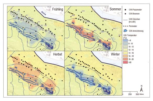
Bild 4: Hydraulisches und thermisches Grundwasserregime für die verschiedenen Jahreszeiten 2014 im Hardwald im Frühjahr (15. April), Sommer (15. Juli), Herbst (15. Oktober) und Winter (15. Januar). OW: Observation Well, GW: Grundwasser. Quelle Landeskarte: swisstopo.
