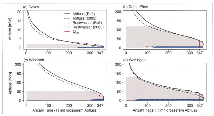
Bild 4: Dauerkurven der Kraftwerke (a) Davos, (b) Domat/Ems, (c) Windisch und (d) Wettingen. Dargestellt sind jeweils die Dauerkurven und Restwasservolumen ( $Q_{rw}$ , blau) der Referenzperiode (Ref.; ausgezogene Linie) und der Zukunftsperiode (2085; gestrichelte Linie) sowie das für die Wasserkraft nutzbare Abflussvolumen ( $Q_{nutz}$ , grau). Die rote Linie repräsentiert den  $Q_{347}$ -Wert. Die Abbildung wurde inspiriert von Hänggi et al. (2012) und SCCER (2019).
