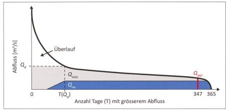
Bild 3: Illustration der Dauerkurve für die Analyse des Restwasservolumens ( $Q_{\rm rw}$ , blau), des für die Wasserkraft nutzbaren Abflussvolumens ( $Q_{\rm nutz}$ , grau) sowie des aufgrund der Limitierung durch die Ausbauwassermenge ( $Q_{\rm d}$ ) nicht genutzten Volumens (Überlauf).  $Q_{\rm 347}$  (rot) indiziert jenen Abflusswert, der an 347 Tagen erreicht oder überschritten wird. Die Abbildung wurde inspiriert von Hänggi et al. (2012).
