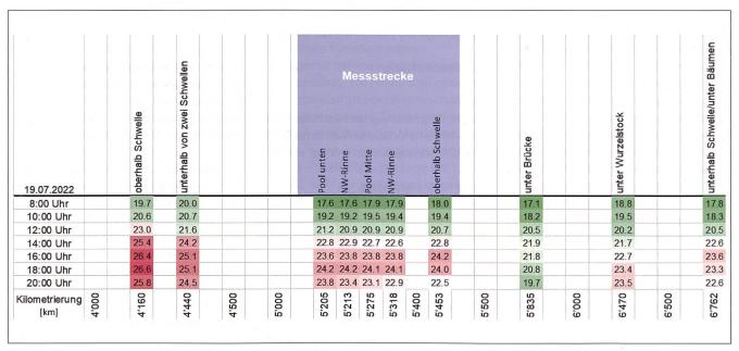
Bild 14: Temperaturmessungen im Wasser am 19.07.22 um 8:00, 12:00, 16:00 und 20:00 Uhr (die Kilometrierung ist verzerrt zur Verbesserung der Lesbarkeit).
