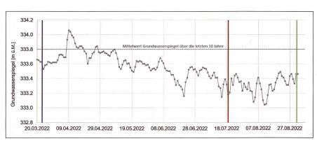
Bild 10: Kantonale Grundwassermessstelle Neumatt II in Frick, mit Eintrag der Messtage der Wassermengenmessung.
