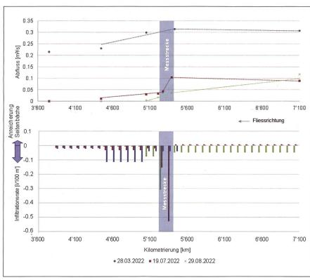
Bild 9: Oben: Wassermengen im Längsverlauf zwischen km 7'200 und km 3'600. Messungen im Juli und August 2022 mit einer Genauigkeit von ±10 Prozent. Unten: Versickerung (Infiltration) und Anreichung entlang der Sissle zwischen km 7'100 und km 3'600.
