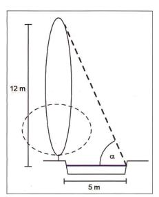
Bild 15: Bei einem Sonnenwinkel a von 67° über der Horizontalen ist bei einer Sohlbreite von 5 m eine Höhe der Bepflanzung von rund 12 m notwendig (Moosmann, Schmid, Wüest, 2005).
