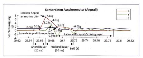
Bild 5: Detailansicht der Accelerometerdaten vom Anprall (7,14 g in Längsrichtung) eines SmartWood-Stammes an das rechte Flussufer nach einer Messzeit von rund 29 s.
