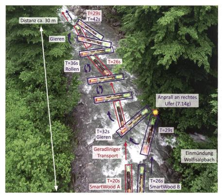
Bild 6: Vergleich von Schwemmholzdynamiken anhand von zwei SmartWood-Stämmen (A in rot & B in blau) in einem Gewässerabschnitt an der Grossen Melchaa. Die Messzeit (T) basiert auf den IMU-Daten und zeigt auf, wie sehr sowohl die Transportgeschwindigkeit als auch individuelle Bewegungsprozesse variieren können.
