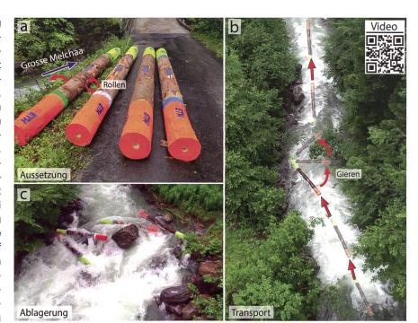
Bild 3: Eindrücke der ersten SmartWood-Versuche im Natur-Massstab an der Grossen Melchaa (Kanton Obwalden). Vier SmartWood-Stämme wurden manuell in das Gewässer ausgesetzt (a), mobilisiert und transportiert (b) und schliesslich im Gewässer abgelagert (c).
