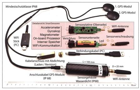
Bild 1: Smart-Sensor zur Verwendung in der Schwemmholzforschung.
