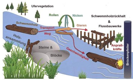
Bild 9: Messung und Rekonstruktion von Schwemmholzdynamiken in Fliessgewässern; Bild adaptiert von Spreitzer et al. (2021).
