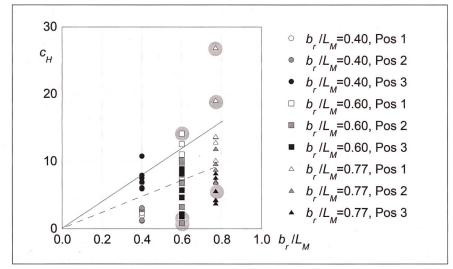
Figure 6: Coefficients de trainée à l'écoulement  $c_H$  induits par les bois flottants contre le râtelier complet en fonction de l'espacement relatif des barres du râtelier, avec une tendance linéaire.
