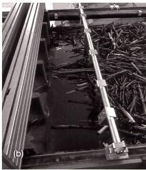
Figure 5: Exemple d'obstruction du râtelier (a) complet (test 18) et (b) partiel (test 72) dans le modèle. Dans le cas du râtelier partiel, certains troncs s'appuient également contre les piliers.
