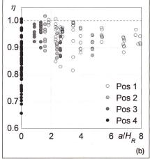
Figure 10: Pour le râtelier partiel et l'apparition de bois individuel: (a) probabilité d'obstruction P et (b) capacité hydraulique  $\eta$ .
