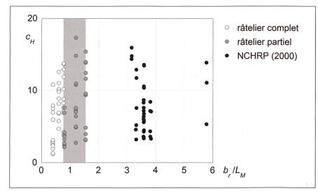
Figure 8: Coefficients de trainée cH induits par les bois flottants estimés à l'aide des données de NCHRP (2000) et de notre approche (F<sub>o</sub>>0,02).
