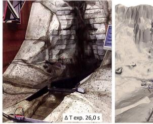
Bild 9: Momentaufnahmen der Ausleitung. Im Bereich der Strasse kommt es in der Fliessbewegung der Front zu Verzögerungen (Foto aus IBU Institut für Bau und Umwelt, 2020).
