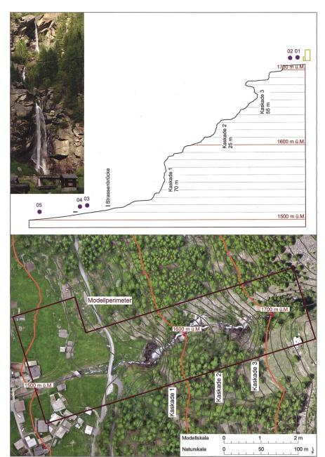
Bild 3: Modellperimeter und Längsgefälle des physikalischen Modells. Im Längsprofil markieren die Punkte 1 bis 5 die Messquerschnitte und das Symbol
