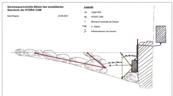
Bild 5: Gerinnequerschnitts-Skizze des modellierten Standorts der Unterwasserkamera.
