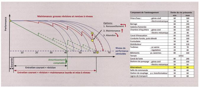
Figure 2: Effet de différentes stratégies de maintenance sur la durée d'utilité d'un actif base des durées de vie présumées définies dans une évaluation du Département de l'Énergie du Valais, 1988.
