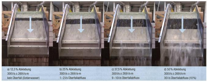
Bild 4: Ermittlung der Fassungskapazität bei schrittweiser Verlängerung der Beschleunigungsstrecke am Standardrechen der Firma Wild Metal GmbH mit 1,0 mm Spaltweite.
