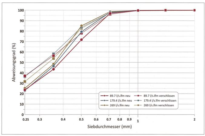
Bild 7: Vergleich der Abweisungsgrade am neuen und am verschlissenen Rechen mit 0,6 mm Spaltweite für Kantkorn bei verschiedenen Durchflüssen.
