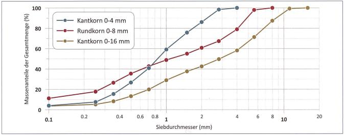
Bild 3: Gemittelte Kurven des Ausgangsmaterials.
