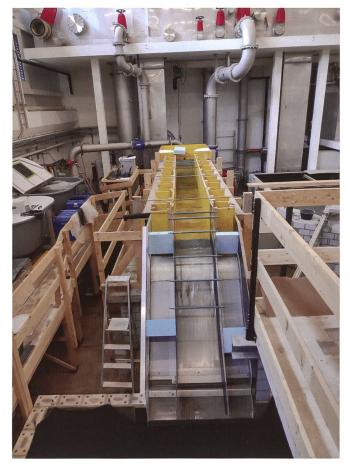
Bild 2: Versuchsstand, Rechenbreite auf 0,5m verschmälert (Anblick vom Unterstrom).
