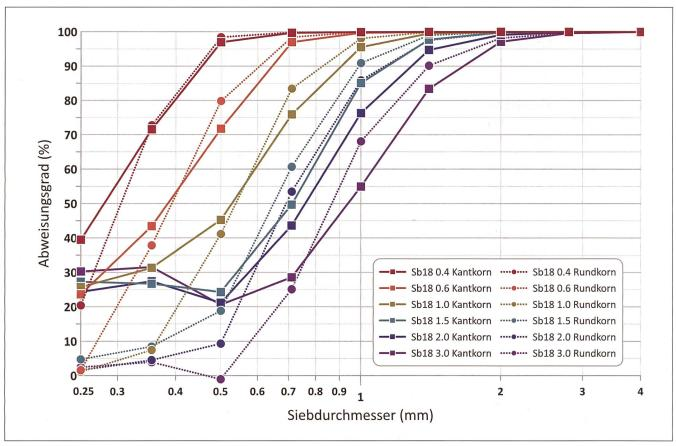
Bild 6: Abweisungscharakteristik aller Standardrechen der Wild Metal GmbH bei spezifischen Durchflüssen von 89,7 l/s·m für Kant- und Rundkorn.
