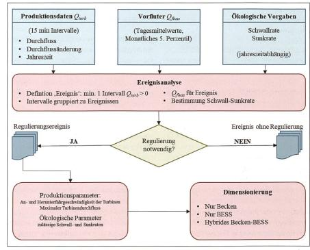
Bild 1: Flussdiagramm zur Ableitung der Bemessungsszenarien.
