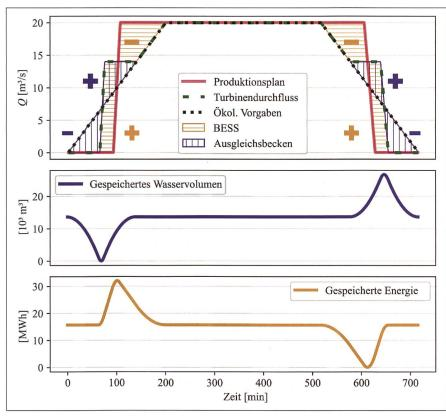
Bild 6: Funktionsprinzip einer Schwall-Sunk-Regulierung mit einem BESS-Becken-Hybrid an einer WKA mit Francis-Turbine: Durchfluss (oben), im Becken gespeichertes Wasservolumen (Mitte) und im BESS gespeicherte Energie (unten) über die Zeit (-: Entleerung des Beckens, +: Füllen des Beckens bzw. +: Laden des BESS, -: Entladen des BESS).
