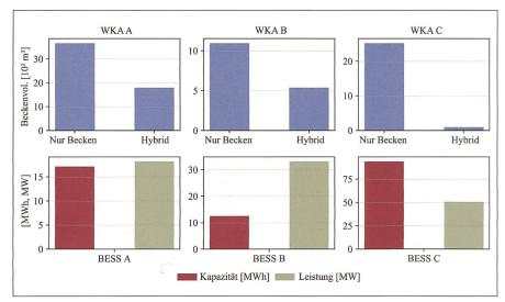
Bild 8: Reduktionspotenzial der Ausgleichsbecken durch hybrides Becken-BESS (oben) und dazugehörige BESS-Kapazitäten und -Leistungen für WKA A, B und C.
