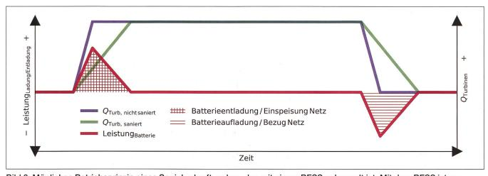
Bild 2: Mögliches Betriebsprinzip eines Speicherkraftwerkes, das mit einem BESS gekoppelt ist. Mit dem BESS ist es möglich, die Turbinen-Stromproduktion langsamer hoch- resp. herunterzufahren. Dies führt zu einer Reduktion der Abflussresp. Pegeländerungsrate unterhalb der Wasserrückgabe (Schwall- resp. Sunkrate).
