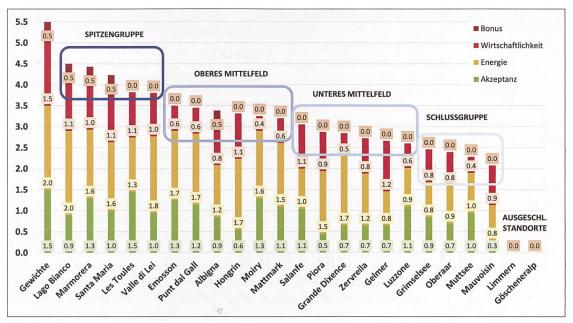
Bild 5: Rangliste der betrachteten FPV-Anlagen mit der Unterteilung in fünf Kategorien. Der erste Balken zeigt die Maximalpunktzahl in jeder Hauptkategorie.
