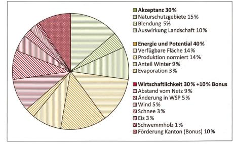
Bild 1: Kriterien und deren Gewichtung, die zur Bewertung der verschiedenen Standorte verwendet wurden, am Beispiel der Bewertungsmatrix für FPV. Der Bonus wurde für Anlagen hinzugefügt, die für zusätzliche kantonale Förderungen infrage kommen. Konkret sind das Anlagen, die in Graubünden liegen und die bestimmten Anforderungen bezüglich der Winterproduktion erfüllen (AEV, 2020).
