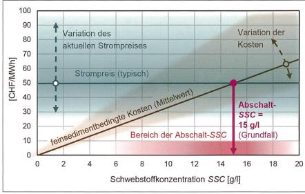
Bild 15: Bestimmung der Abschalt-Schwebstoffkonzentration für das KW Fieschertal.
