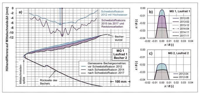
Bild 11: Abrasion an Mittelschneiden a) im Längsschnitt sowie b) und c) im Querschnitt (nachgeführt von Abgottspon et al. 2016).
