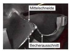
Bild 10: Abgenutzter Becher eines beschichteten Peltonlaufrads (Foto: VAW).
