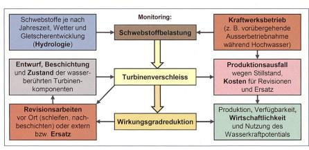
Bild 1: Einflussfaktoren, Auswirkungen und Handlungsmöglichkeiten (orange) betreffend hydro-abrasivem Verschleiss an hydraulischen Maschinen.
