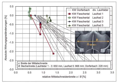
Bild 14: Wirkungsgradabnahme mit zunehmender relativer Mittelschneidenbreite.
