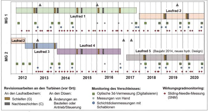
Bild 3: Zeitliche Übersicht über den Laufradeinsatz, die Revisionsarbeiten und die Messungen am KW Fieschertal.
