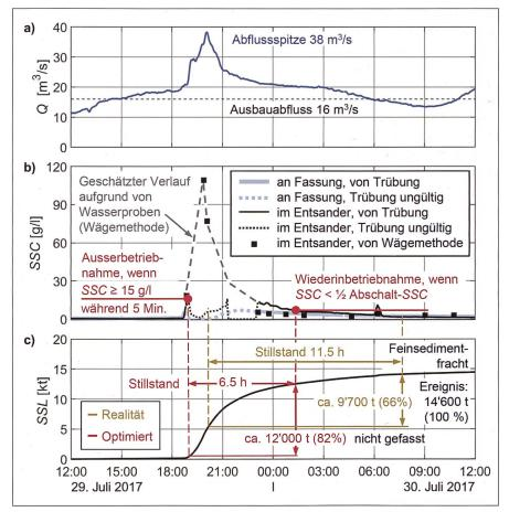
Bild 8: Hochwasser vom 29./30. Juli 2017: a) Zufluss Q, b) Schwebstoff-konzentration SSC bei der Wasserfassung und im Entsander, c) potenzielle Schwebstofffracht SSL im Kraftwerk, mit durchgeführter Ausserbetriebnahme (hellbraun) und optimiertem Szenario (rot).
