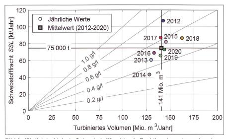
Bild 6: Jährlich turbinierte Schwebstofffrachten in Funktion der entsprechenden Wasservolumina im KW Fieschertal (Betriebsdaten: gkw).
