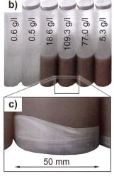
Bild 7: a) Zufluss zur Wasserfassung des KW Fieschertal im Gewitter vom 29. Juli 2017 (Foto: gkw), b) Wasserproben (je 0,5 Liter) vor und während des Hochwassers und c) abgelagerte Feinsedimente in der Probe mit der höchsten SSC (Fotos: VAW).
