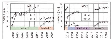
Bild 12: Veränderungen der Mittelschneidenbreite s und der Becherausschnittstiefe c für die beiden MG über neun Jahre.
