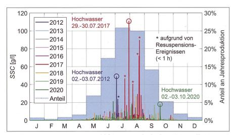
Bild 5: Schwebstoffkonzentration SSC gemessen in der Druckleitung (Schieberkammer) sowie mittlere monatliche Anteile an der Jahresproduktion des KW Fieschertal (Betriebsdaten: gkw).
