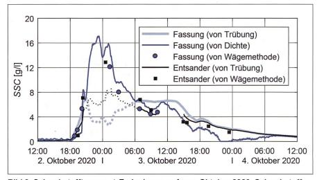
Bild 9: Schwebstofftransport-Ereignis von anfangs Oktober 2020: Schwebstoffkonzentrationen SSC bei den Fassungsbauwerken, die mit mehreren Methoden gemessen wurden (ungültige Messwerte von überlasteten Trübungssonden strichliert).
