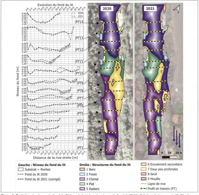
Figure 3: Evolution du niveau du fond du lit (gauche) et des structures du fond du lit (droite) dans le tronçon à dépôts de sédiments. Le niveau de référence à 0 correspond au niveau de la surface d'eau en 2020. © arrière-plan: groupe de recherche Ökohydrologie ZHAW.
