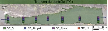
Figure 2: Schémas d'évaluation. Subdivision du tronçon à dépôts de sédiments en deux tronçons partiels (en haut). Positions des quatre dépôts de sédiments de 2016 (ellipses rouges) et positions des profils en travers (traits noirs). L'appartenance des profils en travers aux quatre sous-ensembles SE\_5, SE\_7impair, SE\_7pair et SE\_14 est indiquée par les symboles figurant dans la légende. © arrière-plan: groupe de recherche Ökohydrologie ZHAW.
