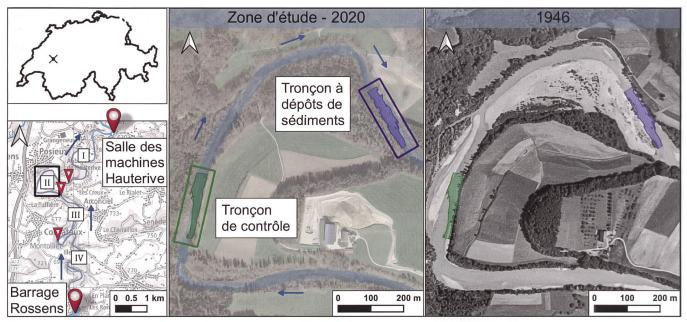
Figure 1: Aperçu de la zone d'étude. Subdivision de la Petite Sarine en quatre tronçons *I* à *IV* pour la cartographie des frayères (gauche). Définition des tronçons d'étude pour les relevés des indicateurs (centre). Morphologie du lit majeur avant la construction du barrage (droite). © arrière-plan: swisstopo.
