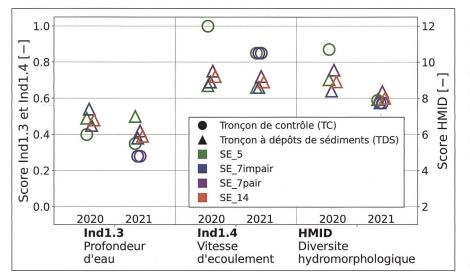
Figure 6: Scores des indicateurs hydrométriques avant et après la crue. Pour chaque indicateur et tronçon d'étude, différents scores sont obtenus en fonction du sous-ensemble (SE) des profils en travers utilisé dans le calcul. Les différents sous-ensembles sont définis dans la Figure 2. L'axe secondaire à droite indique les scores du HMID. L'axe principal à gauche indique les scores des autres indicateurs.
