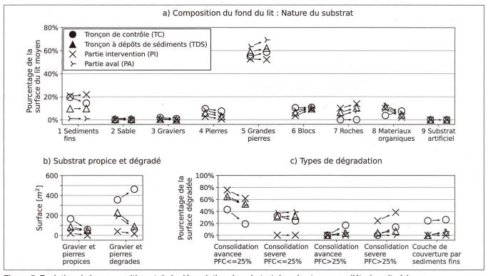
Figure 5: Evolution de la composition et de la dégradation du substrat dans les tronçons d'étude suite à la crue.
