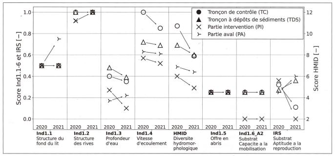
Figure 4: Scores des différents indicateurs avant et après la crue. Pour le tronçon à dépôts de sédiments, les indicateurs hydrométriques sont calculés sur la base du sous-ensemble SE\_14, pour le tronçon de contrôle sur la base du SE\_5. L'axe secondaire à droite indique les scores du HMID. L'axe principal à gauche indique les scores des autres indicateurs.
