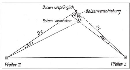
Bild 1: Prinzip des Vorwärtseinschneidens von zwei Pfeilern aus (Lang 1929).
