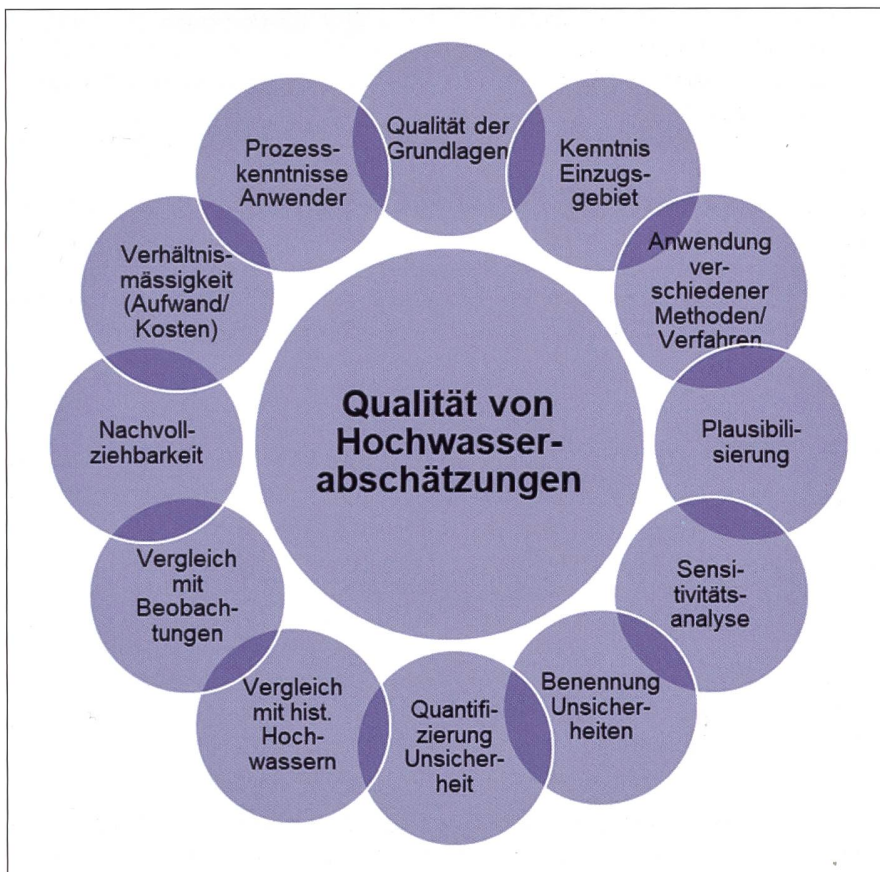
Bild 2: Wesentliche Punkte zur Verbesserung der Qualität von Hochwasserabschätzungen (Abflüsse und Volumina).
